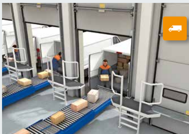
Погрузка и разгрузка автомобилей малой грузоподъемности осуществляется на уровне пола цеха. Для этого полностью открываются ворота, включая секцию цоколя
