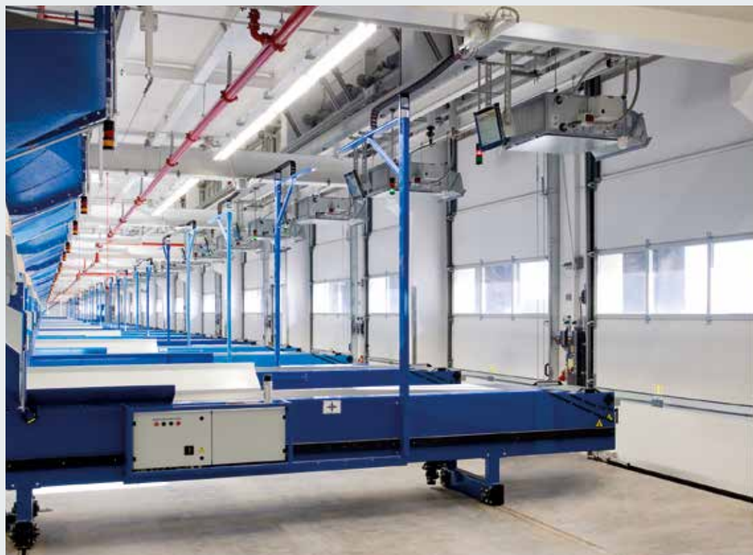
Разъемные промышленные ворота были специально разработаны для логистических центров, напр., для предприятий почтового обслуживания
